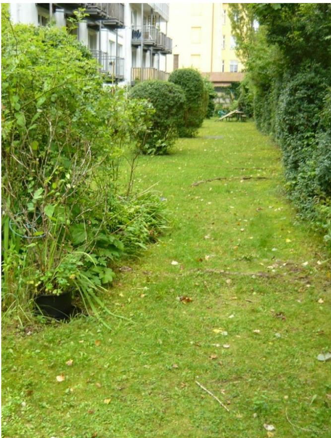
Foto 1: Durch Bewuchs nicht mehr erkennbare und nutzbare Aufstellfläche für Hubrettungsfahrzeuge (betrieblicher Mangel)
